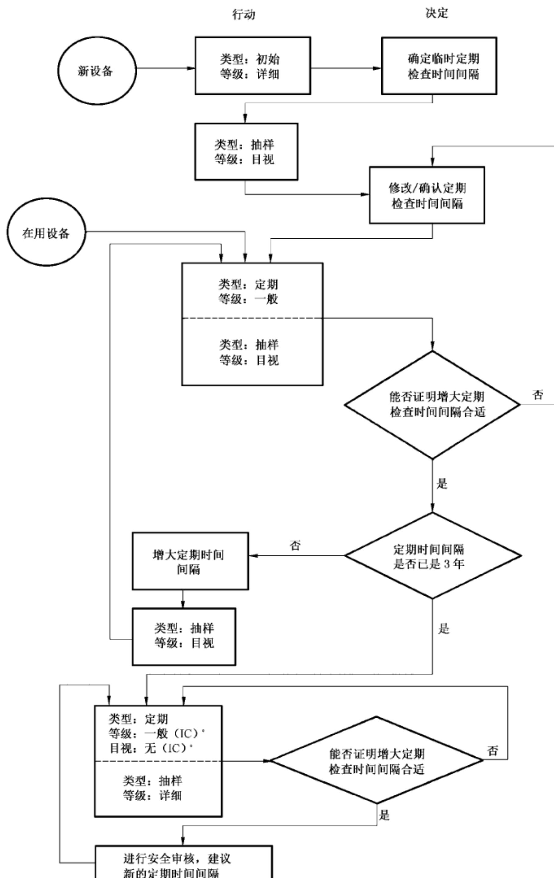
\* IC——正常运行时有点燃能力, 即正常运行时电气设备内部元件产生有点燃能力的电弧、火花或表面温度。
